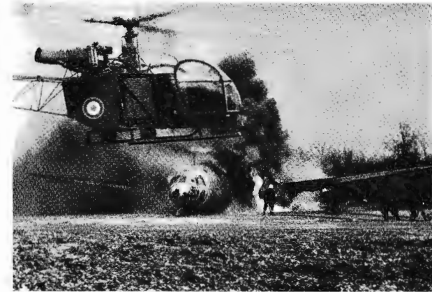
Hubschrauber als Feuerwehr. Ein Hubschrauber bringt einen Feuerlöschtrupp an ein brennendes Flugzeug und hilft durch Rotorwind Flammen und Rauch zurückzudrängen.
