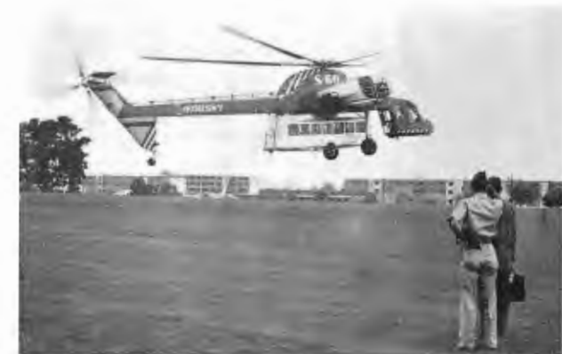
Der fliegende Kran S-60, der SIKORSKY Aircraft, kann auch, wie hier auf dem Bilde, eine Passagierkabine mit 20 Fluggästen befördern.
