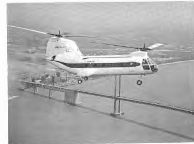
Hubschrauber im Nahluftverkehr. Vertol 107 der Vertol Aircraft Corporation (Sitzkapazität 25 Fluggäste) als Verkehrsflugzeug.
