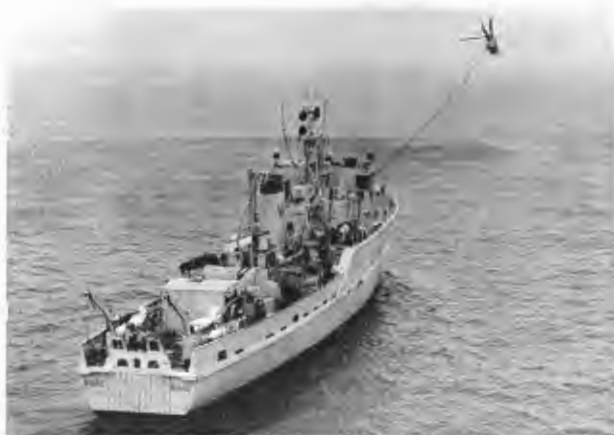
Hubschrauber im Schleppdienst. Hier wird ein nicht mehr manövrierfähiges Schiff von einem Hubschrauber zum Zielhafen geschleppt.
